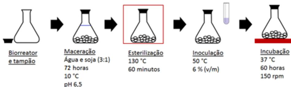
Figura 1. Fluxograma do processo de produção de ácido  $\gamma$ -poliglutâmico utilizando soja como substrato.
